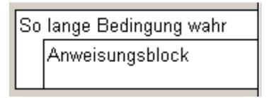
Bedingung wird im SchleifenKOPF geprüft (d.h.: <u>vor</u> erstmaliger Ausführung d. Anweisungsblocks)
